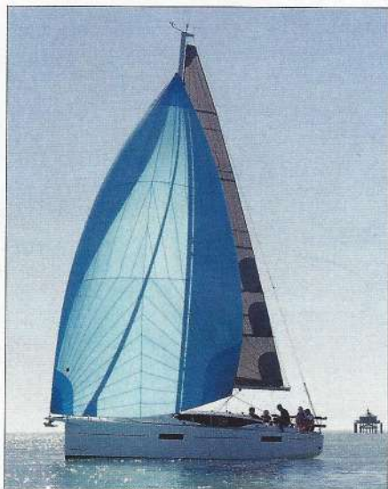
▲ Plan de voilure classique : mât à deux étages de flèche poussantes et gréement fractionné.
